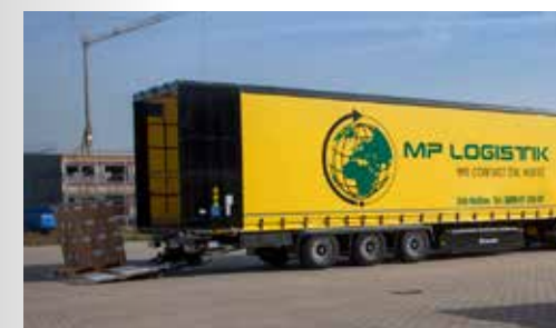
Megatrailer mit Hebebühne: Traglast der Hebebühne bis zu 2 Tonnen
